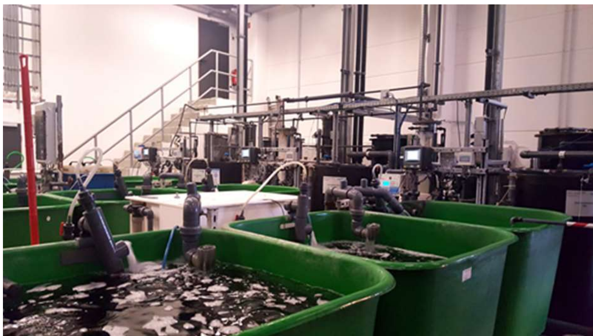
Rysunek 26. Systemy RAS do prowadzenia badań na organizmach morskich, znajdujące się w laboratorium Aquaculture Research Technology Transfer, Alfred-Wegener-Institute (Bremerhaven, Niemcy).
