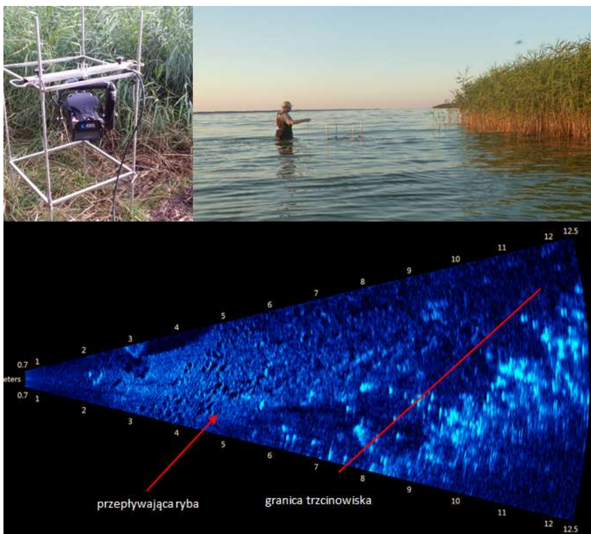
Rysunek 19. Sonar ARIS zamocowany do konstrukcji użytej w trakcie pomiarów (lewe zdjęcie) oraz ustawiony na skraju trzcinywiska - na miejscu pomiarów (prawe zdjęcie) oraz obraz zarejestrowany sonarem (dolny rysunek).
