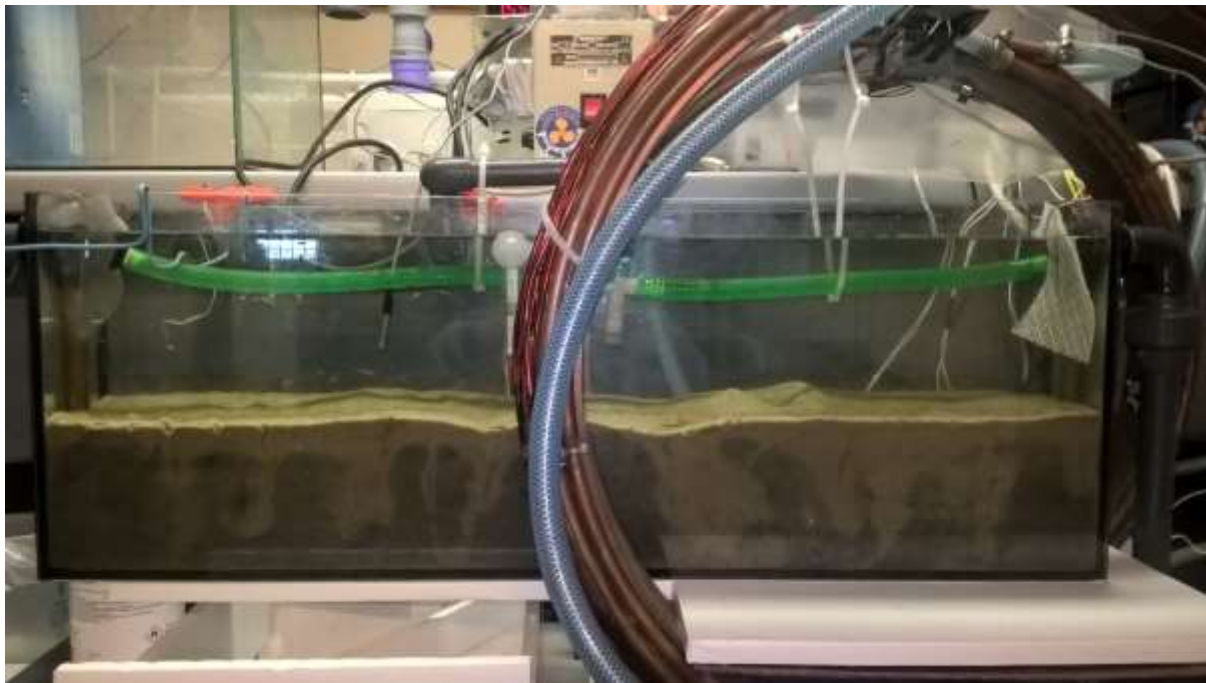
Rysunek 37. Zestaw eksperymentalny przedstawiający generator pola magnetycznego i akwarium do badań behawioralnych bentosu
