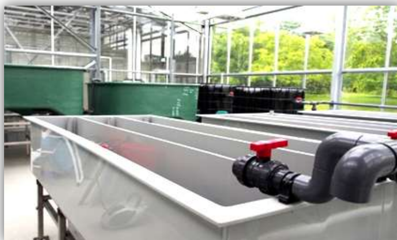
Rysunek 20. Fragment instalacji eksperymentalnej do hodowli w systemie akwaponicznym, znajdujący się na Uniwersytecie w Rostoku
