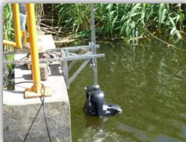
Rysunek 12. Stanowisko pomiarowe oraz sposób mocowania sonaru ARIS przy przepompowni w Nowym Batorowie.
